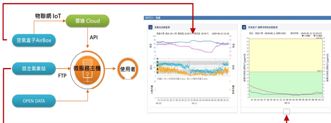
圖1. 左方為高雄微服務架構，由高雄大學提供實體主機，透過物聯網資訊串連及API技術，整合高雄大學的感測儀器、氣象局及環保署OPENDATA。右方為高雄微服務其中一個模組，即時顯示高雄大學自動觀測儀器及空氣盒子數據。
