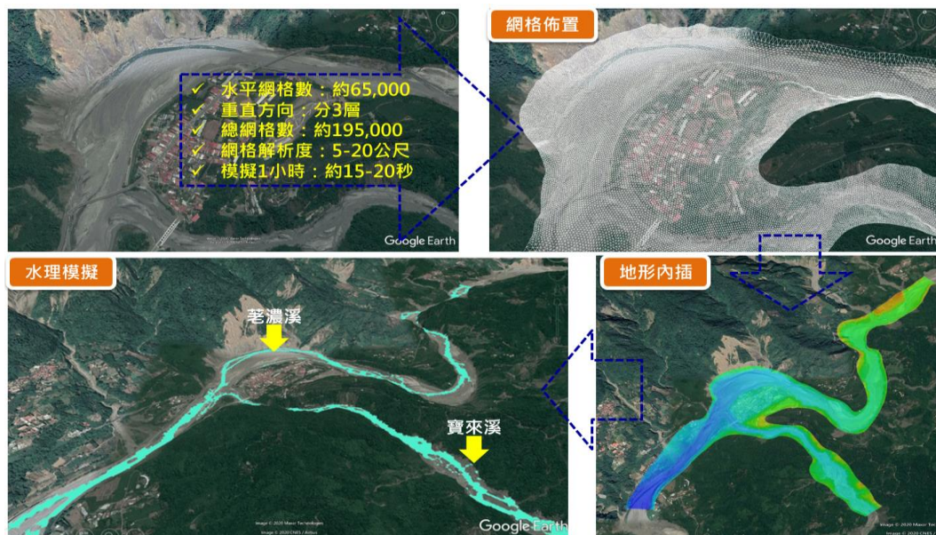
圖15、高地洪氾區淹水預警系統之水動力核心模式建置流程
