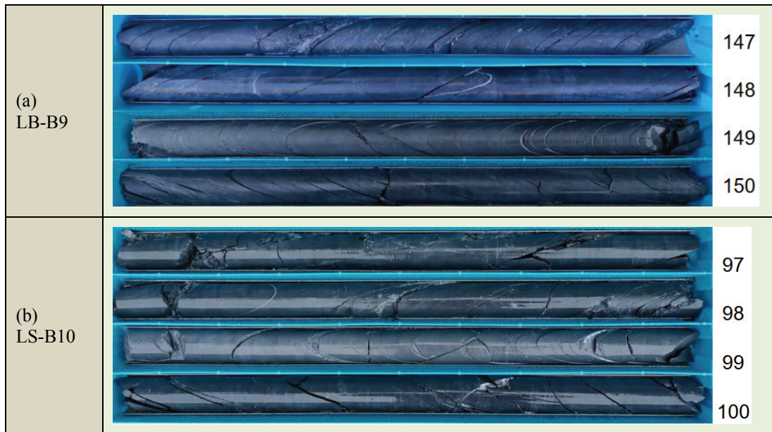
圖6、LS-B9及LS-B10岩芯照片。岩性以粉砂質板岩為主(本計畫彙整)
