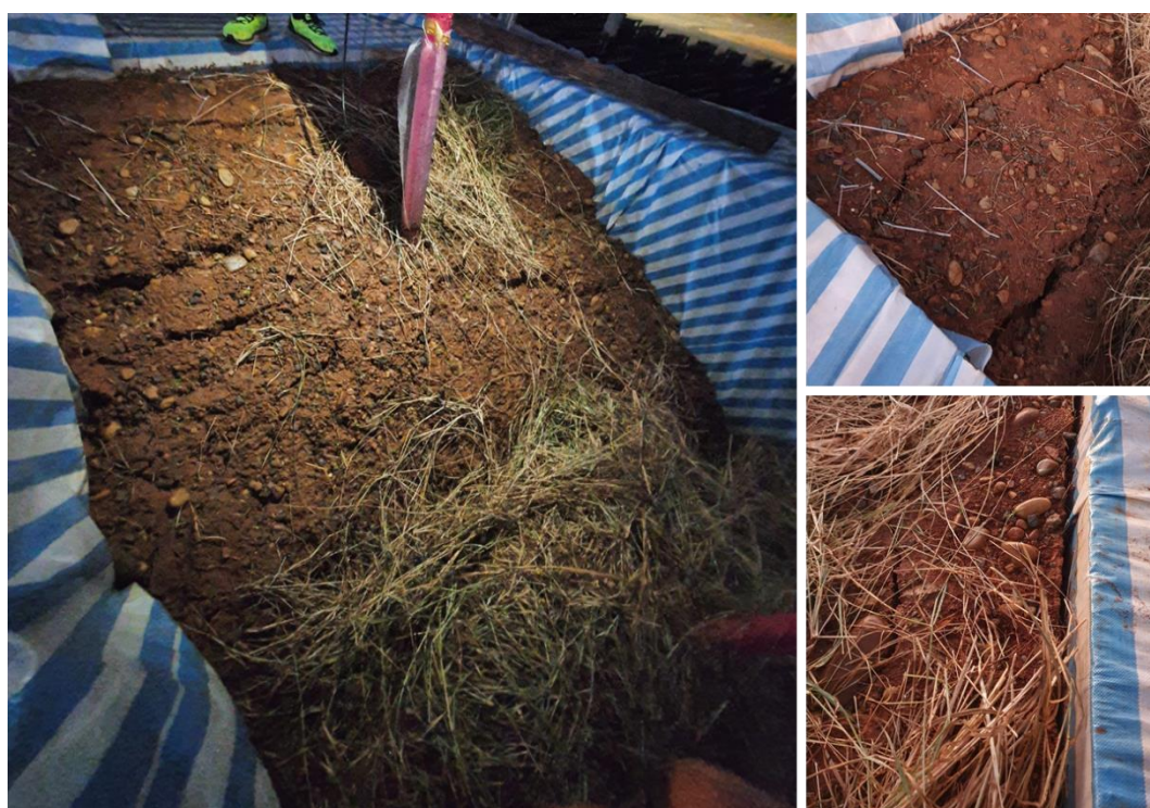
圖 13 草皮下方裂縫發展情形三 邊坡穩定模擬與數值分析
