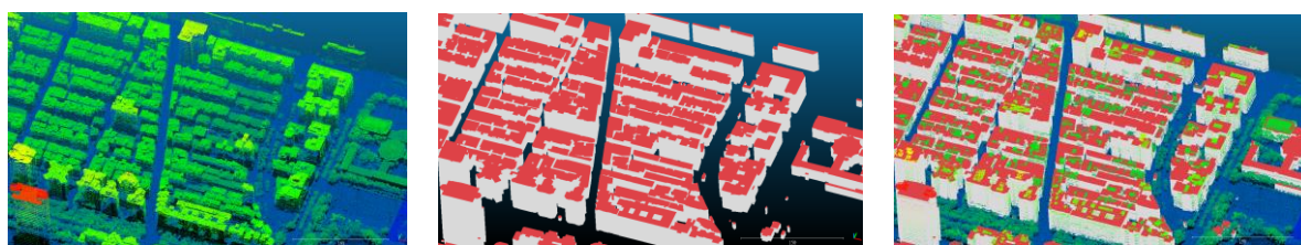
(a)三維點雲 (b)以 1/1000 數值地形圖房屋輪廓形塑之三維模型 (c)1/1000數值地形圖之三維模型與三維點雲套疊
