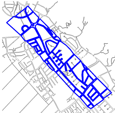
圖 14 光達資料道路數化成果套疊電子地圖
