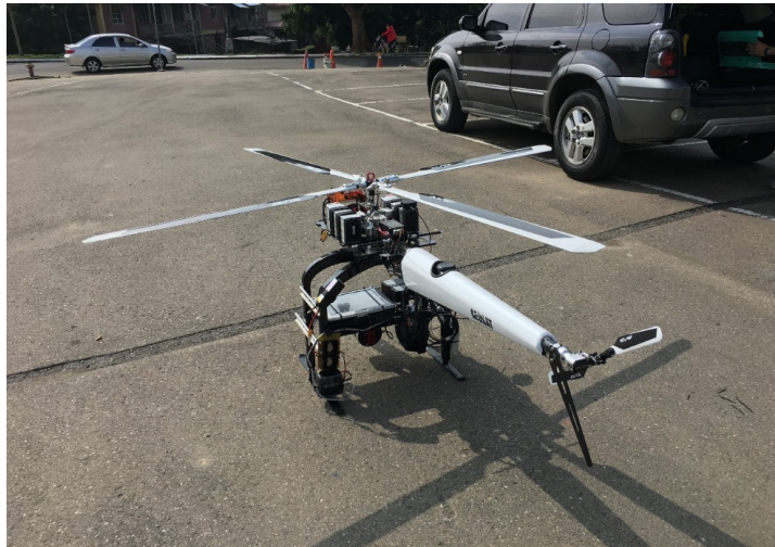
圖 7 單旋翼型 UAS 整合光達設備
