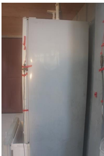
圖 50、冰箱照片(1Hz 342gal 磁磚地 坪 伸縮桿)
