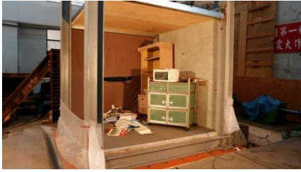
圖 18、書櫃損壞(地毯地坪 1Hz 577gal 伸縮桿)
