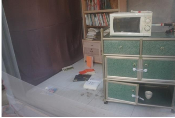
圖 24、餐具櫃位移(磁磚地坪 1Hz 441gal 無固定)
