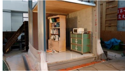
圖 19、書櫃位移+散落(磁磚地坪 3Hz 320gal 無固定)
