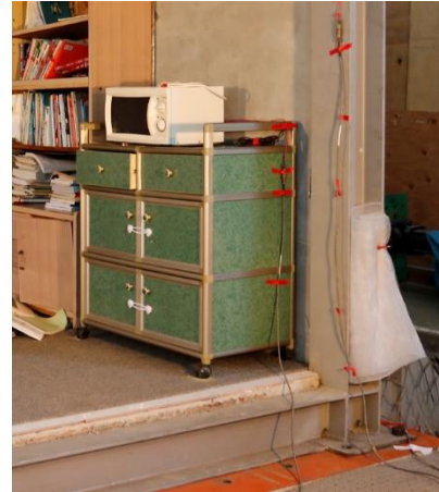
圖 25、餐具櫃抽屜滑出(地毯地坪 3Hz 679gal 防震消能墊)
