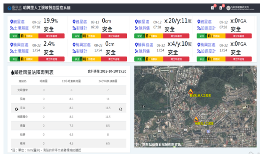
(1) 明興里人工邊坡智慧監控系統首頁
