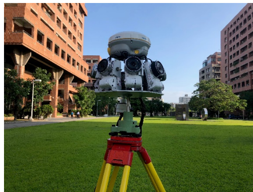
圖 16、(a)新PPIMS之平台硬體設計 (b)新PPIMS 整體外觀
