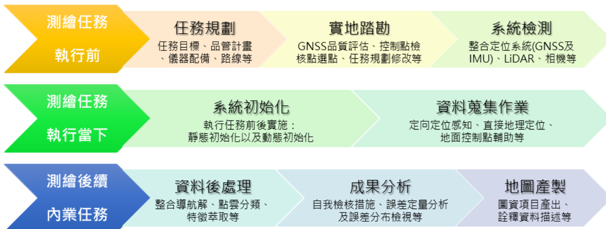
圖 20、高精地圖製圖作業之車載行動測繪系統建議流程
