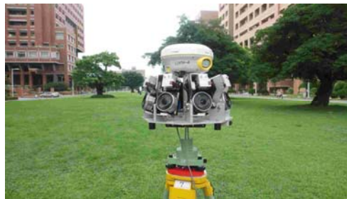
圖4、可攜式環景影像測繪系統
