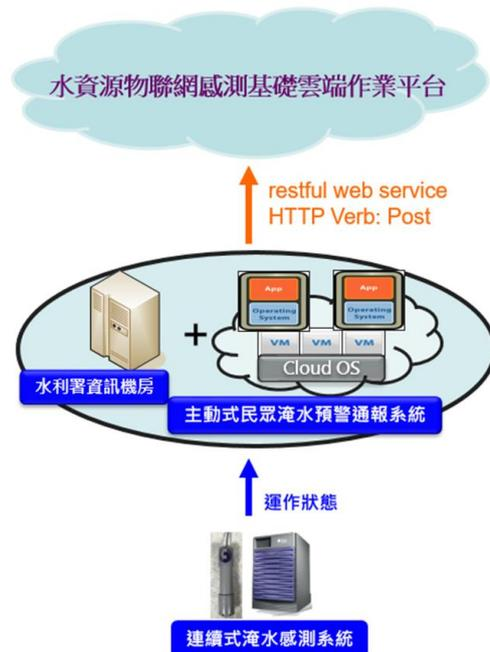
圖3.2-2 感測器運作狀態上傳「水資源物聯網平台」架構圖
