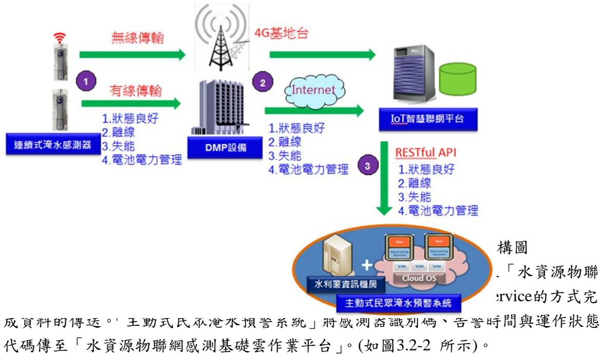
圖3.2-1 主動式民眾淹水預警系統架構圖。圖中展示了感測器、DMP設備、4G基地台、IoT智慧聯網平台、水利署資訊機房、Cloud OS以及主動式民眾淹水預警系統的組成和數據傳輸流程。
