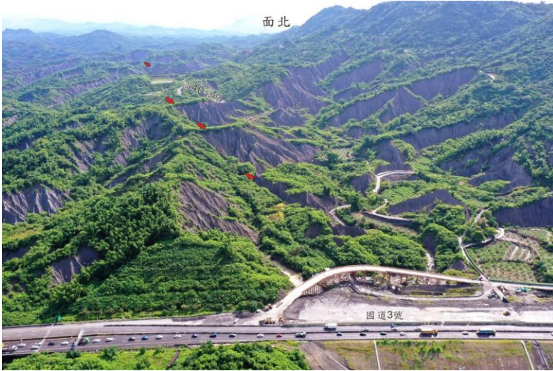
圖 8、國道 3 號往北側眺望空照。高 40 公路南側至國道 3 號北側露頭之間，可連續追蹤車瓜林斷層帶(紅色箭頭)。
