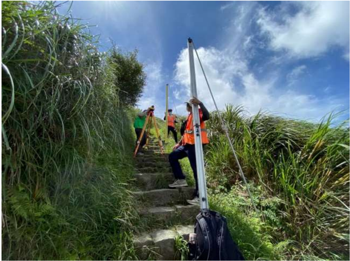
圖 14 精密水準測量野外作業。
