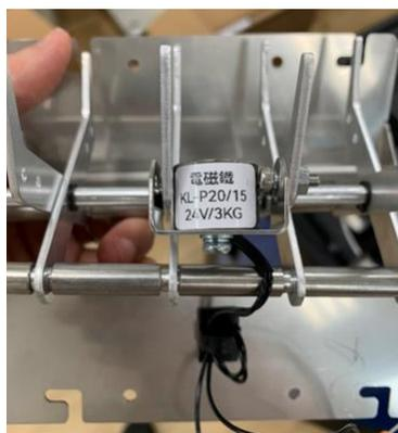
圖 9 管式夾爪配置電磁裝置
