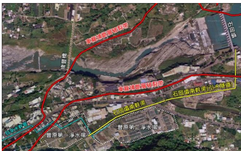
圖2-1 九二一地震石岡、豐原附近斷層破裂帶與重要原水與淨水設施分布
