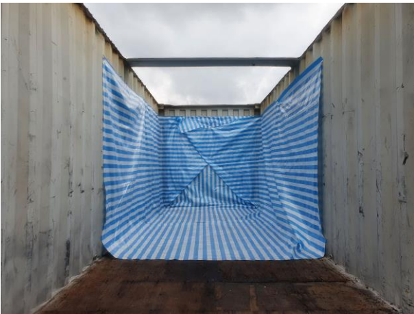
圖 1 土槽內部鋪設不透水帆布，上方保留 20cm 鋼板。
