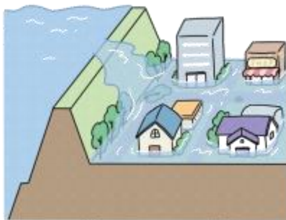
圖 2-11 外水溢堤災害
