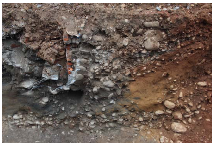
圖 2-4、舊后里國中槽溝西牆，SG 層與 G1 層傾動變形，朝西拍攝。
