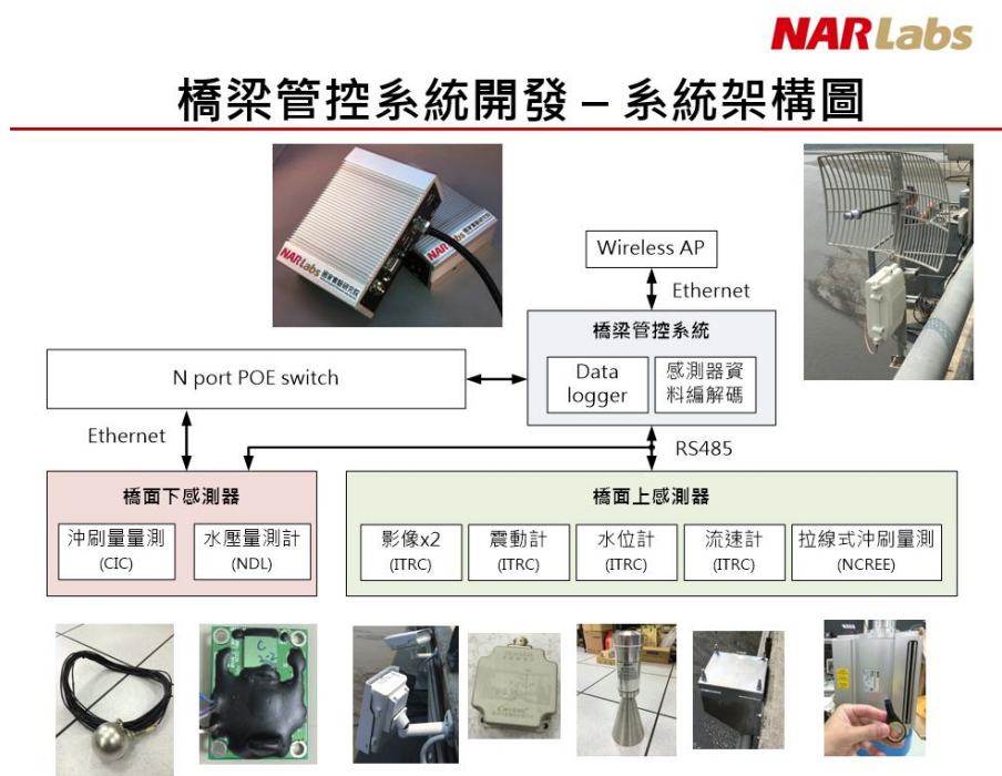
圖 1:橋樑管控系統架構圖
