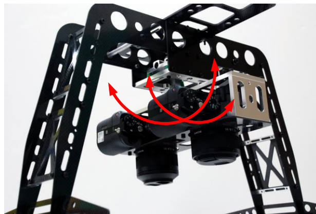
圖 6、自穩式兩軸穩定雲台
