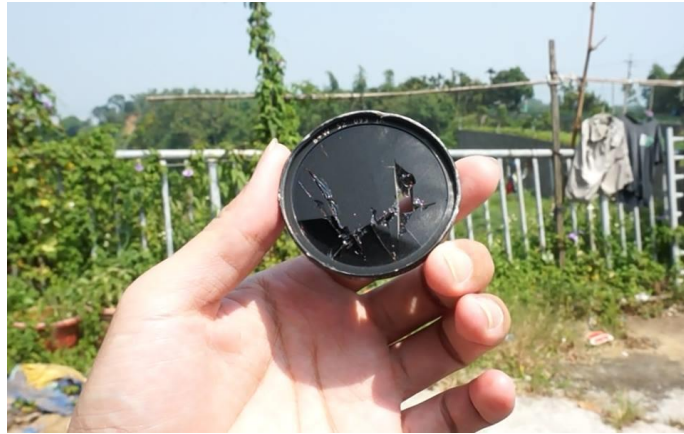
圖 2、第一代快速取像系統重落地損毀
