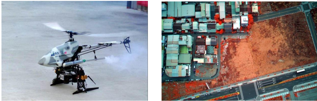
圖 7、第二代 4 波段快速取像系統_任務執行與拍攝成果
