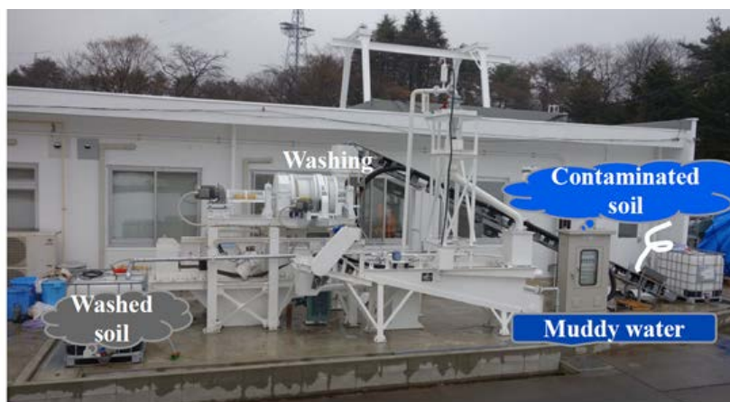
圖 3、日本處理受污染土壤之儀器
