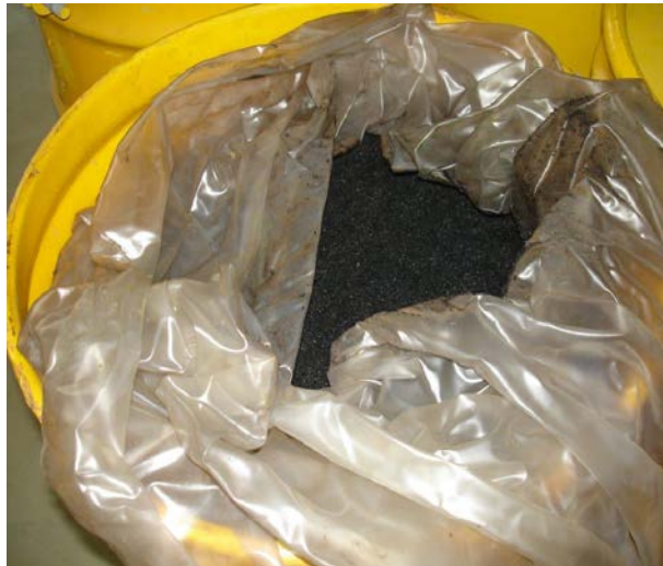
圖 2、整桶過濾器活性碳(充填率 90%)
