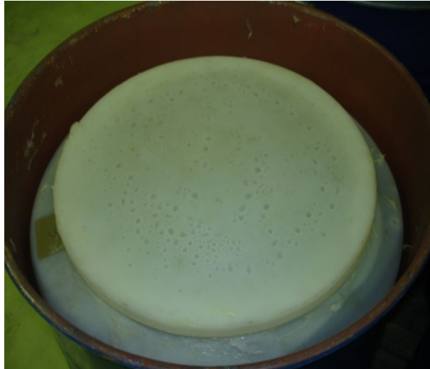
圖 1、整桶樹脂(充填率 96%)
