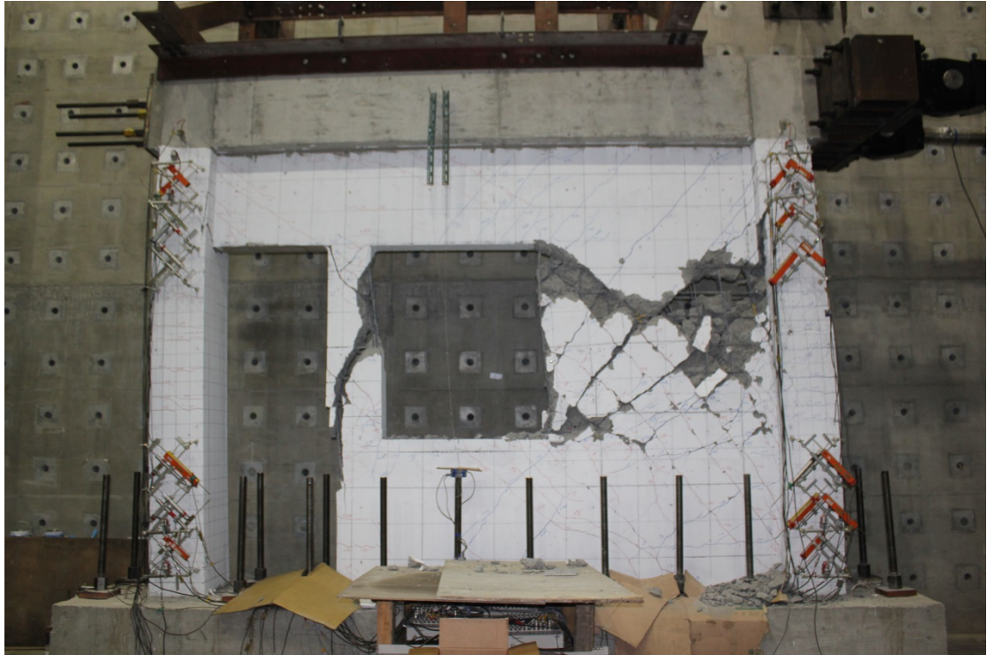
圖 3 試體 3 最終破壞情形
