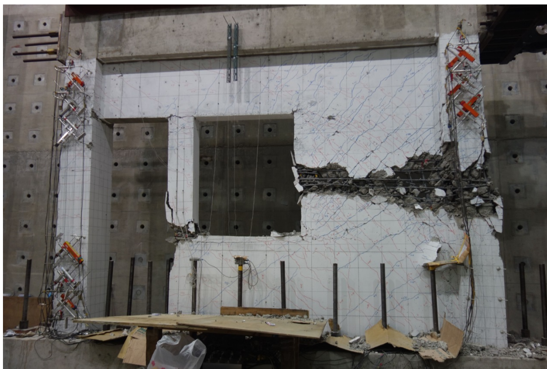
圖 5 試體 5 最終破壞情形
