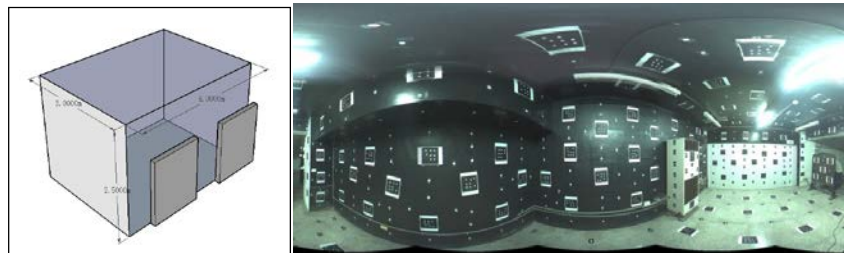
圖 3.4 立方體率定場示意圖及率定場全景影像範例
