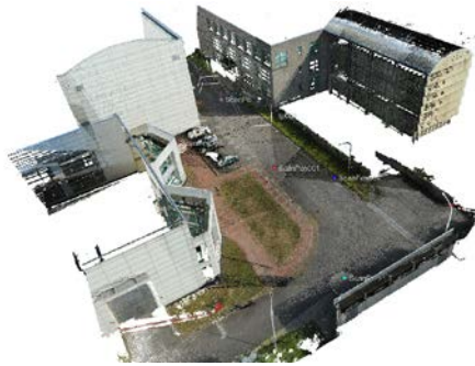
圖 4.1 地面光達掃描及拼接後成果 3D 透視圖
