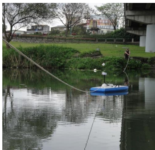
圖 8、聲波都卜勒流速剖面儀(RiverSurveyor M9)於宜蘭河中山橋操作情況。
