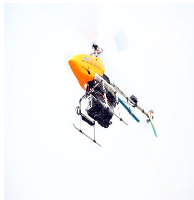
圖 4 具有 4 波段取像模組之弦翼無人飛行載台控制系統
