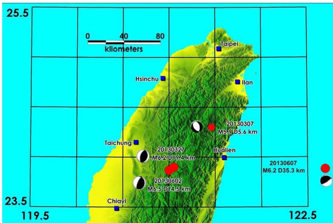
圖 21、2013 年以來發生於台灣地區的 4 個顯著地震(紅色實心圓)，每個地震的斷層面解繪於其側。
