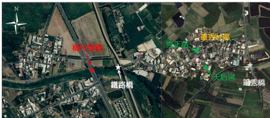
圖 6、筆秀社區內外水位監測儀器位置示意圖
