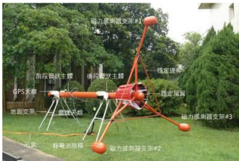
圖 3、三軸拖鳥組裝完成後照片及各部組件名稱
