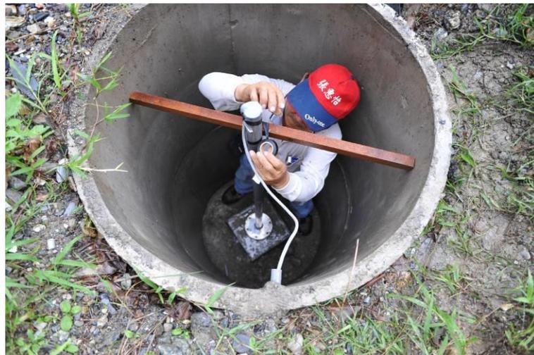
圖 8：南安國中示範站 2m 淺井式地震儀裝置照片
