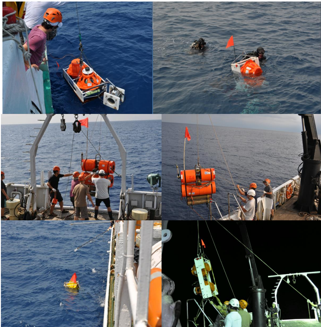
圖 7、海上作業—海底地震儀佈放及回收
