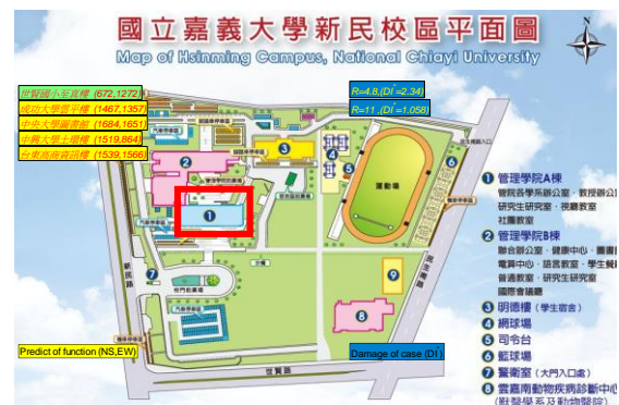
圖 15 嘉義大學新民校區管理學院 A 棟於 2500 年回歸期人工地震之最大加速度預估與震損預估圖
