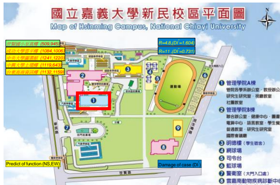
圖 12 嘉義大學新民校區管理學院 A 棟於 475 年回歸期人工地震之最大加速度預估與震損預估圖
