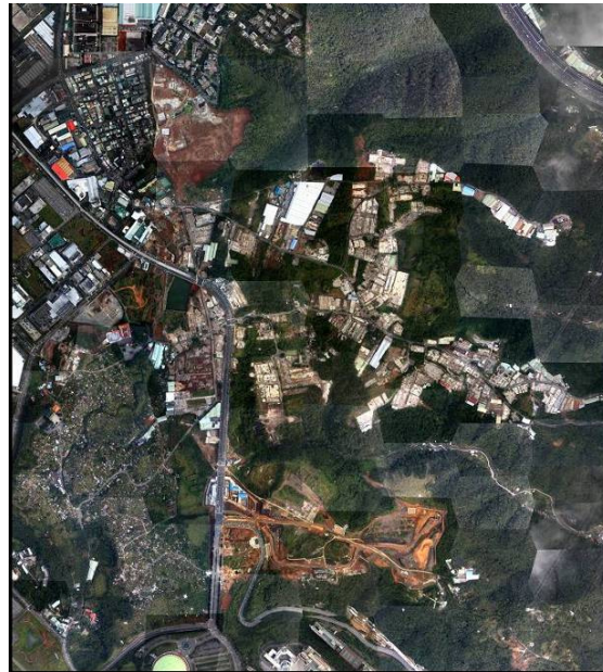
圖 6、桃園機場捷運 UAS 影像產製之正射影像
