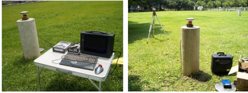
圖 1.4 高精度位置與航向基樁之室外靜態測試場之實測過程
