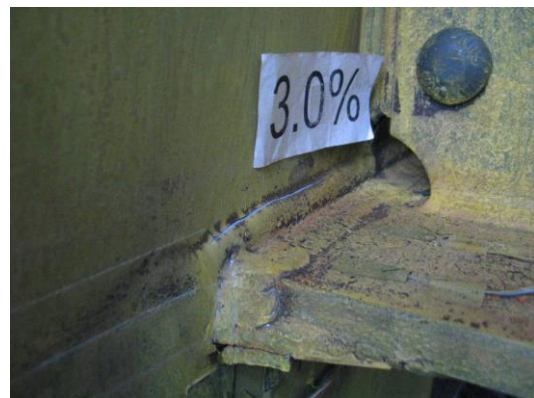
圖 13 試體 EE 於尖峰位移角 0.03 弧度時，對應上下翼板之柱板受拉拱起情況
