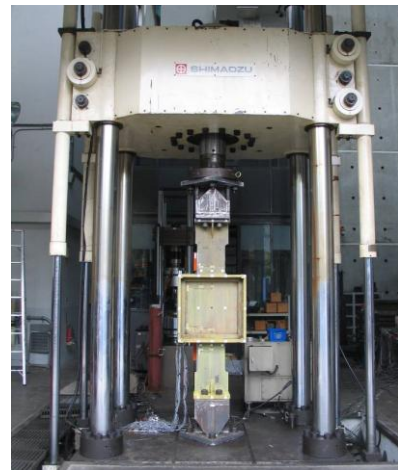
圖 6 ESW 元件試體架設圖
