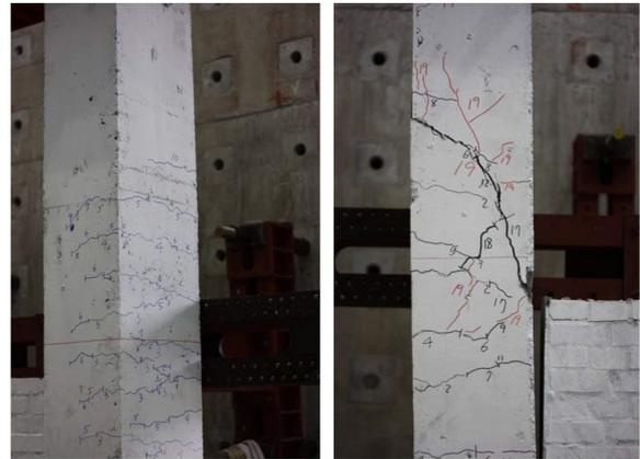
(a) 產生明顯斜切裂縫 (b) 混凝土發生嚴重崩落
