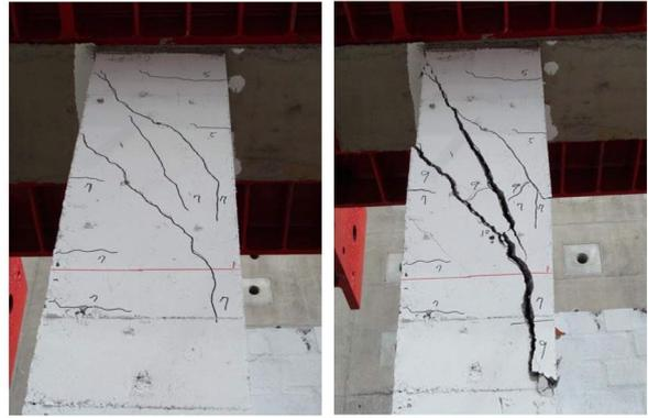
(a)短柱區出現剪力裂縫 (b)裂縫加大且勁度強度驟降
