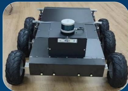
圖5 遙控輻射偵測平台，採六輪獨立馬達驅動，並可更換輪型，以因應多元地貌變化。
