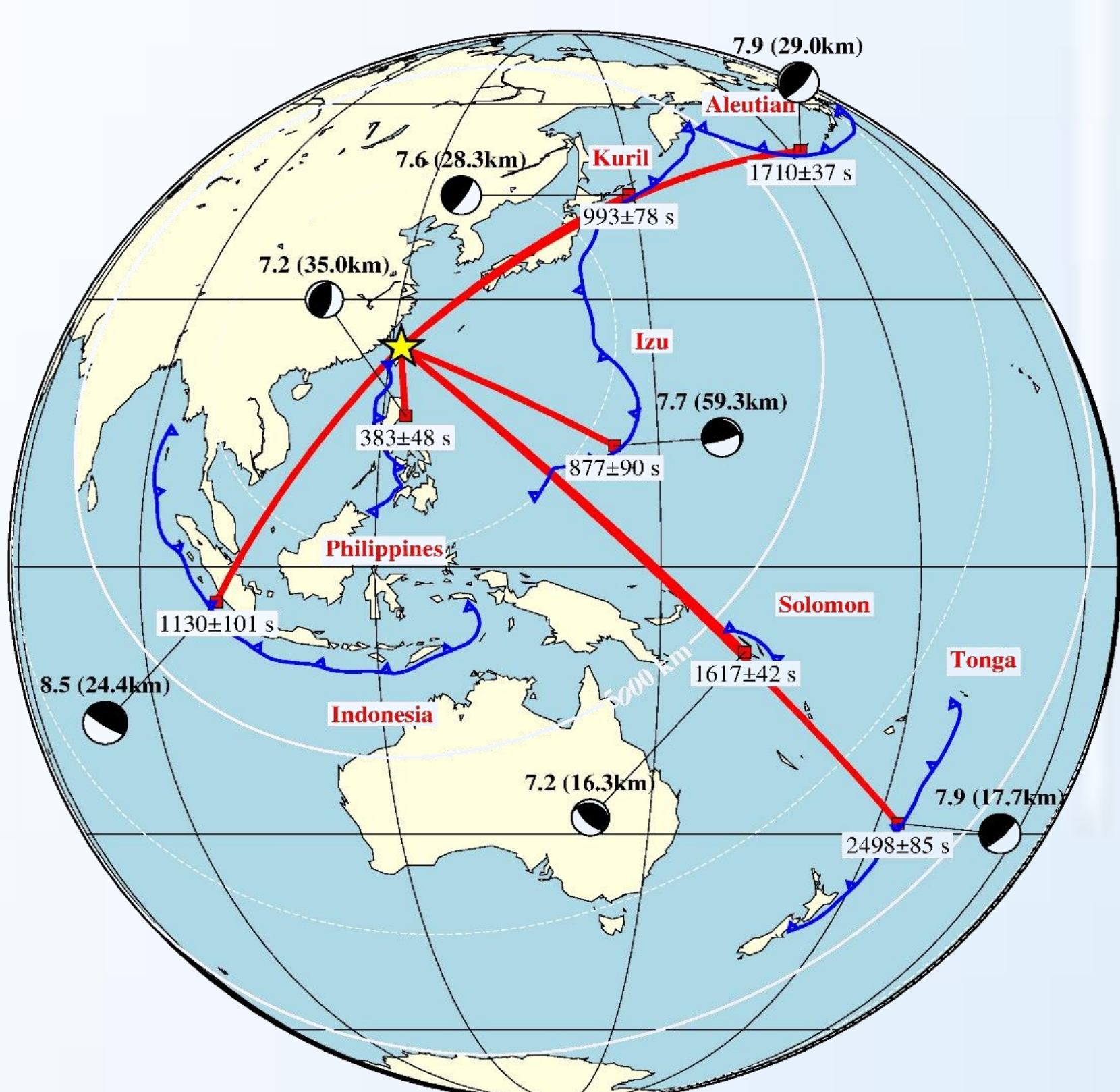
圖四、研究區域(德基站(TDCB))與七個隱沒帶之相對位置，本研究使用七個地震事件作為波形反演案例，亦建立表面波走時，估算全球任一隱沒帶地震發生後表面波抵達臺灣的預警時間，因表面波最大振幅是地震規模和震央距的函數，本研究使用格林函數工具進行波形反演，推測表面波的最大振幅及到時，成果如右。
