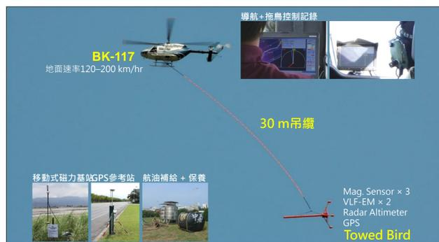
圖2 空中磁力探測所使用之儀器設備
