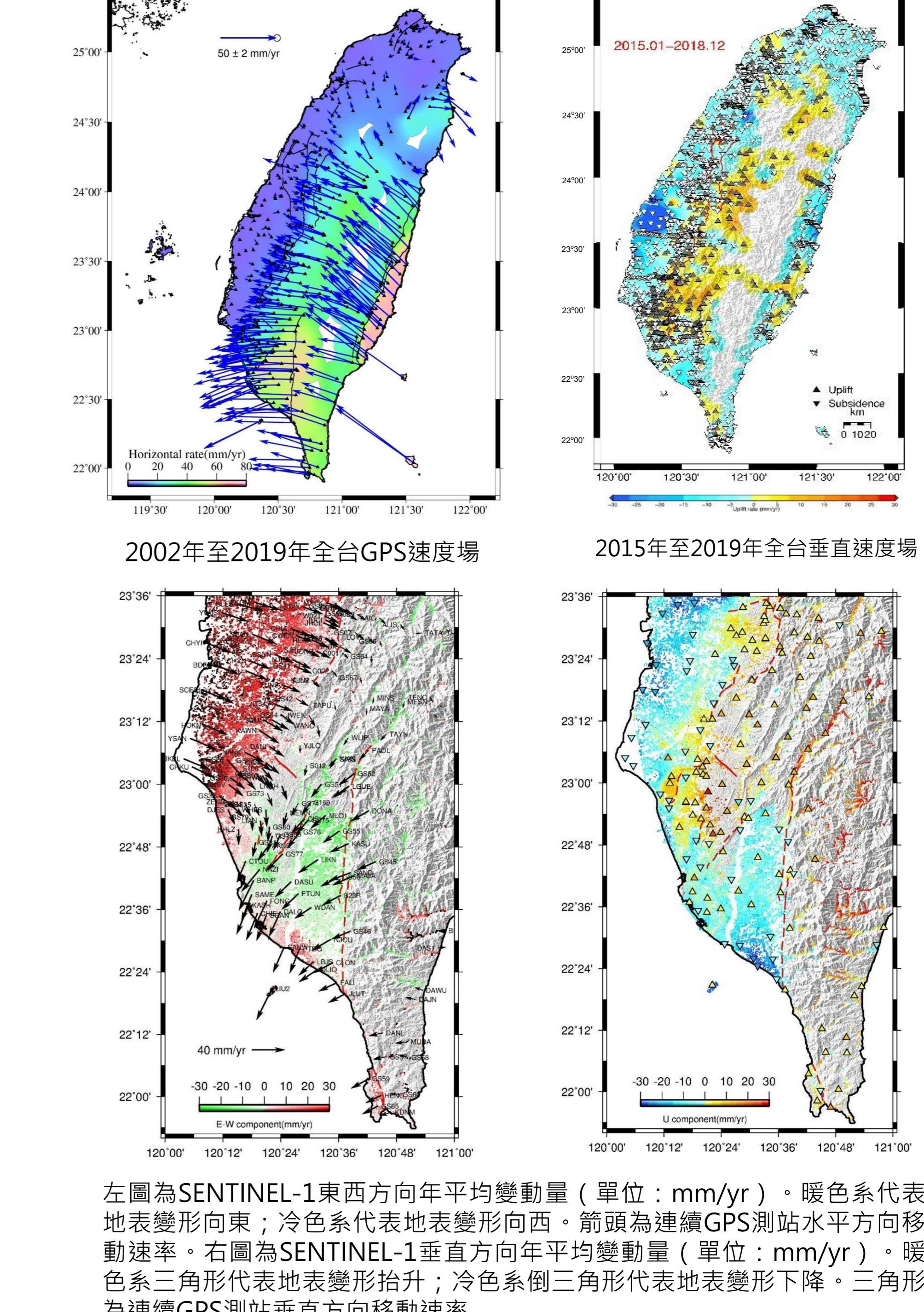
左圖為SENTINEL-1東西方向年平均變動量（單位：mm/yr）。暖色系代表地表變形向東；冷色系代表地表變形向西。箭頭為連續GPS測站平方向移動速率。右圖為SENTINEL-1垂直方向年平均變動量（單位：mm/yr）。暖色系三角形代表地表變形抬升；冷色系倒三角形代表地表變形下降。三角形為連續GPS測站垂直方向移動速率
