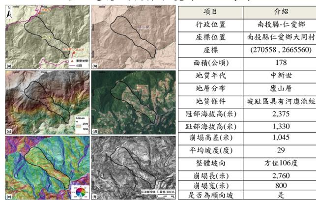
圖2.崩塌地形資訊分布圖(a)地理位置圖;(b)地質圖;(c)地表高程圖;(d)航照影像圖;(e)坡向圖;(f)坡度圖
