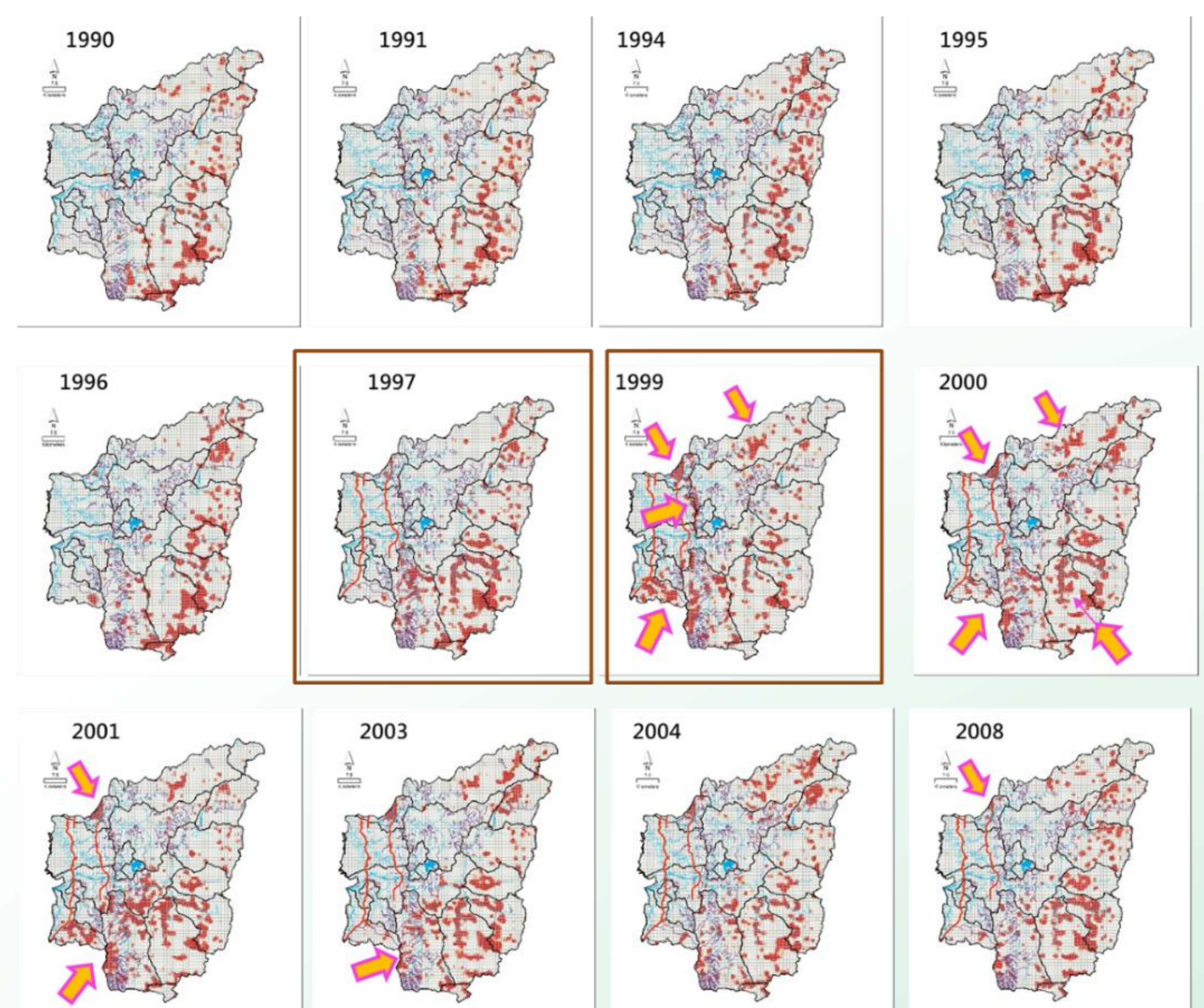
南投縣崩塌熱區的空間變化(以Landsat影像資料判釋崩塌)
