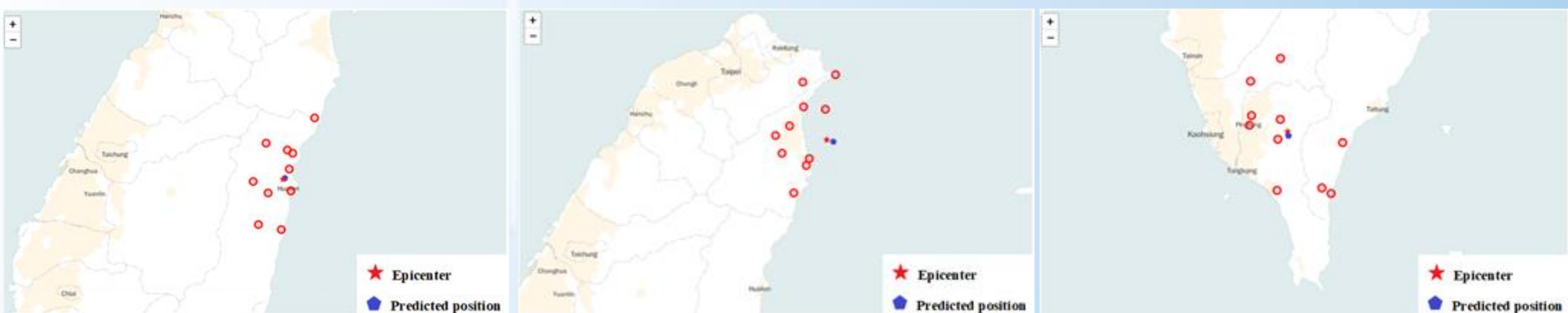
圖四、本計畫中應用於定位的應用以2018年全年地震事件做為測試資料評估神經網路模型的效果，2018年全年約16199筆事件，在震央位置上的誤差與中央氣象局紀錄的位置平均差距4.78公里，深度平均差距4.56公里，而在僅使用前10個收到P波之測站作為預測得到位置平均差距4.83公里，深度差距5.46公里。而圖三為一範例，採用台北時間2018/02/13 00:00之地震紀錄，使用前10個收到P波之測站定位結果，圖中五邊形為實際震央，星形為本研究所定出之震央，圓形為測站。
