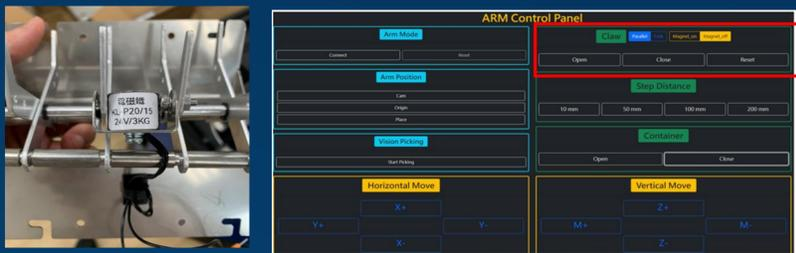
圖5 管式夾爪配置電磁裝置與中控操作介面
