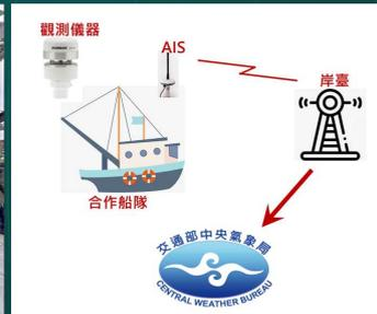
透過海上遍布船隻作為海氣象儀器載具，與各式國籍船隊合作，建立行走的海上氣象站，運用AIS或衛星將資料傳回陸地上的岸臺，最終傳至氣象局，111年完成3艘合作船，圖中為其一的臺馬之星。
