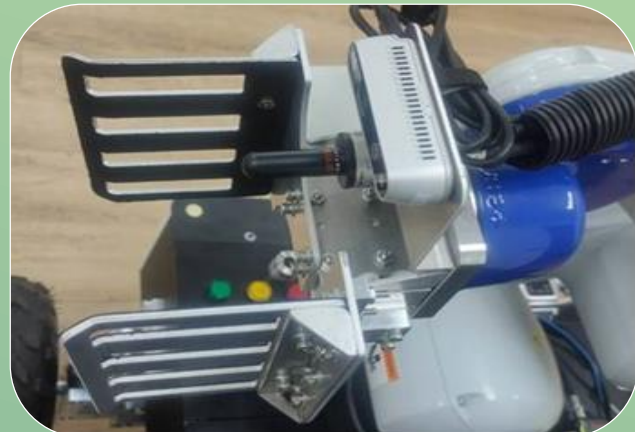
圖4 電動雙片式夾爪搭載深度相機與輻射偵檢頭
