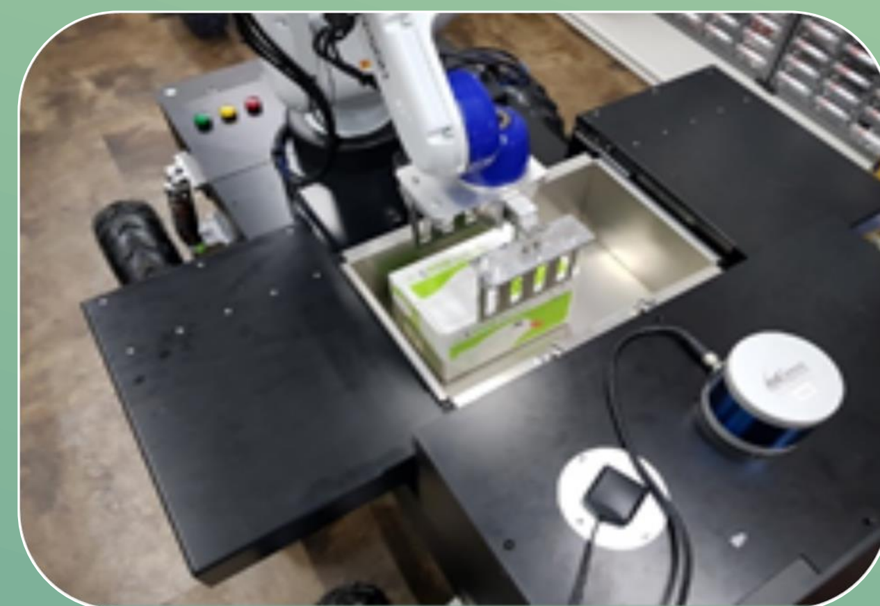
圖7 電動收納艙收放實測
