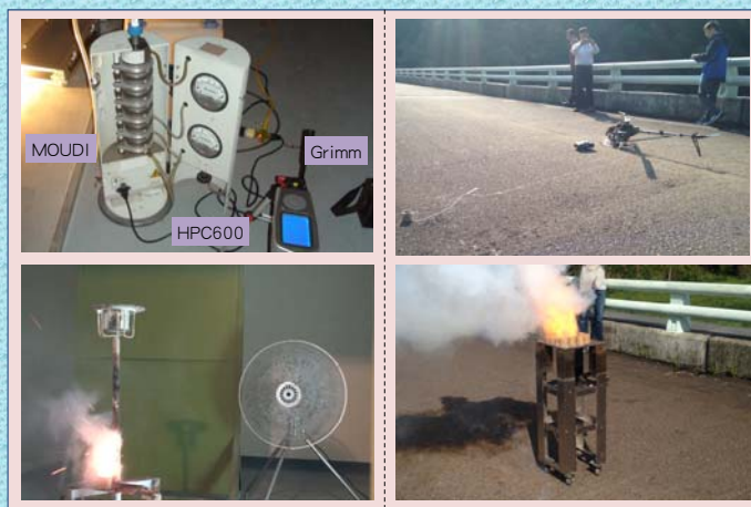
圖2 新型暖雲焰劑之廠內測試（左）及野外作業實驗（右）。
