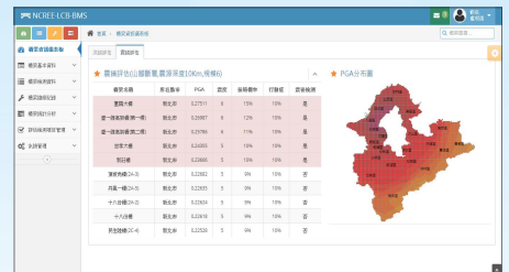
結合氣象局地震速報與橋梁地震災損評估，提供損壞機率排序，協助管理單位快速進行橋梁之安全檢測
