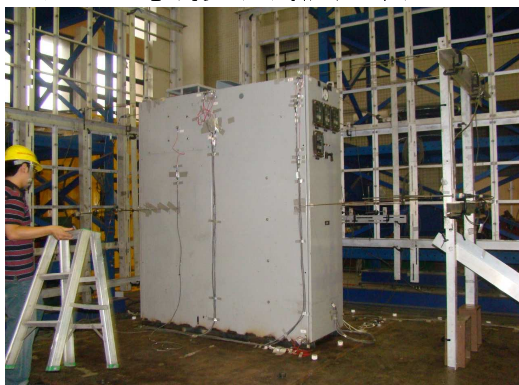
核三廠電氣盤體機櫃振動台試驗
