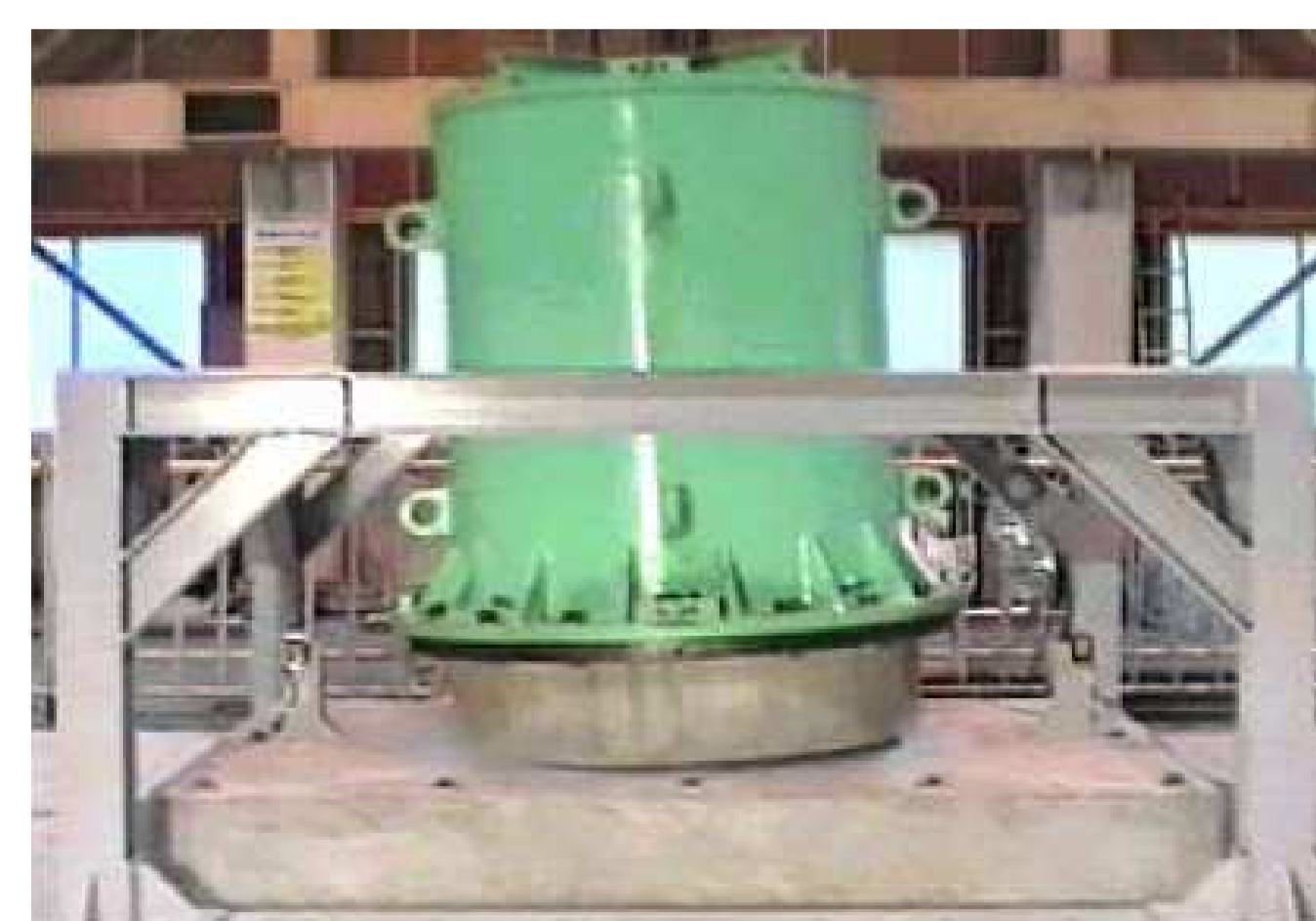
CRIEPI 1/3縮尺護箱模型試驗
