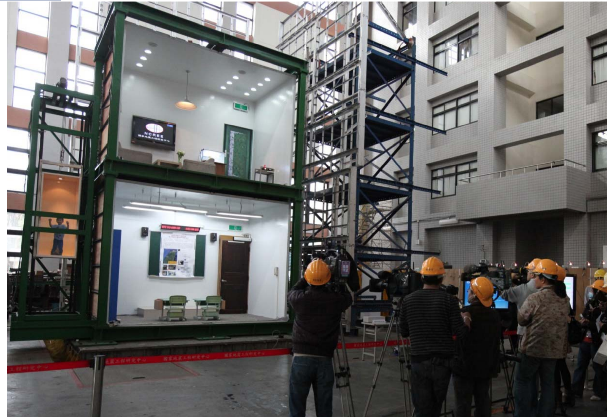
振動台實機整合測試照片：可為嘉義,台中,新竹,台北爭取11,7,17與27秒的預警時間
