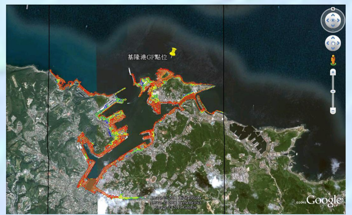
基隆港波高6公尺入射波溢淹狀況
